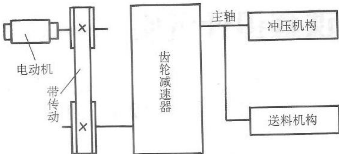
图 2 冲床的传动系统
